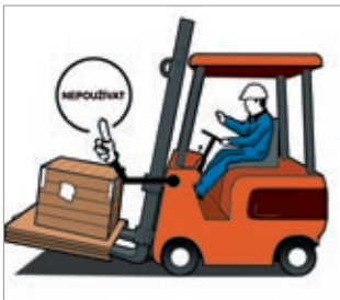
Vyradený zdvíhací vozík
